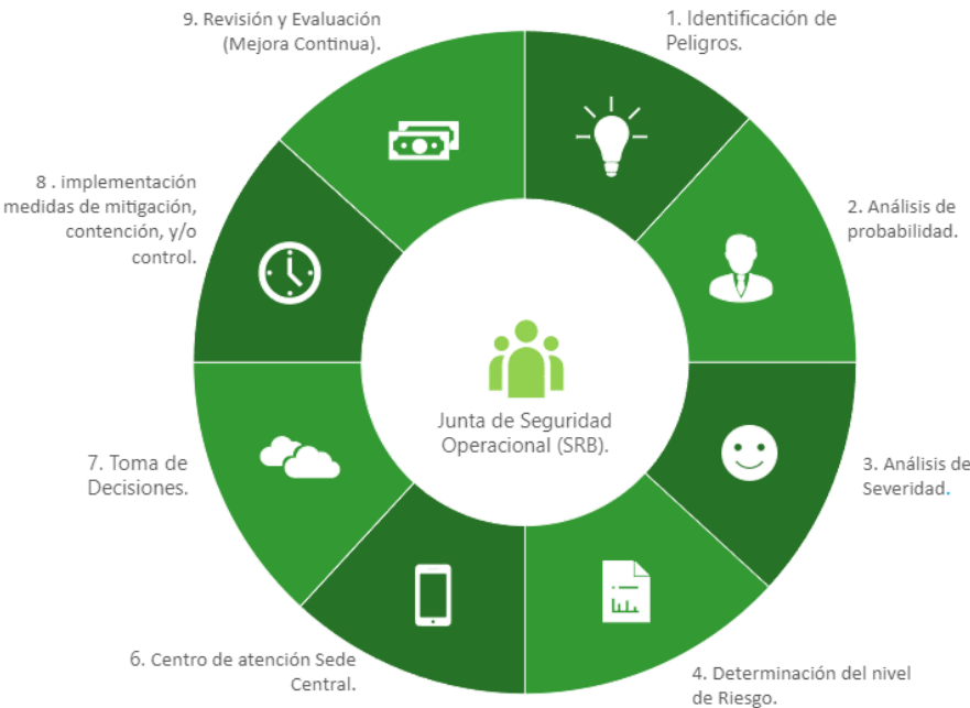
Ilustración 1 Proceso de Gestión del Riesgo de seguridad operacional para operaciones con UAS. (Elaboración propia)
